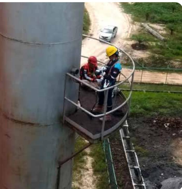
Pengukuran emisi cerobong asap pabrik kelapa sawit di PMP.
